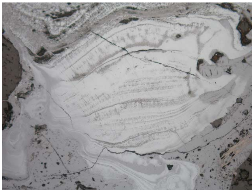
Obr. 3.3: Zonální stavba produktů oxidace železářské strusky. 18. století. Jednotlivé zóny se liší zejména stupněm hydratace. Lokalita Rajnochovice. Spodní strana snímku měří 0,72 mm.
