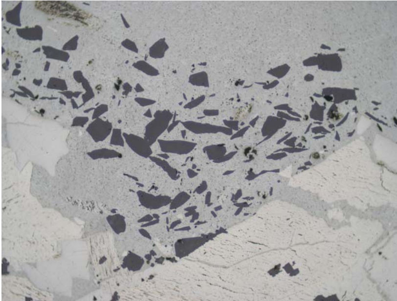
Obr. 5.13: Drť křemene (šedočerný), tmelená jemnozrnným hematitem (světle šedý). Brekciace křemene a krystalizace hematitu proběhly po vzniku velkých individuí pyroluzitu (bílý) ve spodní části obrázku. Žilná Fe-Mn mineralizace, Horní Blatná. Spodní strana snímku měří 1,44 mm.
