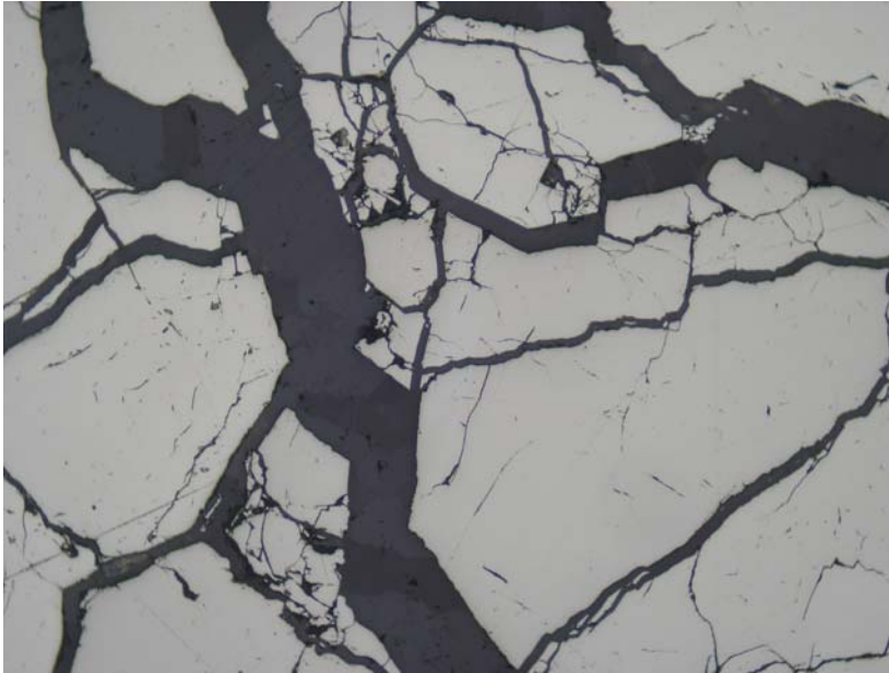
Obr. 5.10: Iniciální stádium křehké deformace, spojené se vznikem žilek „se sobě odpovídajícími stěnami“. Postiženým minerálem je markazit (bílý), výplň žilek tvoří kalcit (šedočerný). Markazitová kongrece z jurského vápence, Kurovice. Spodní strana snímku měří 1,44 mm.
