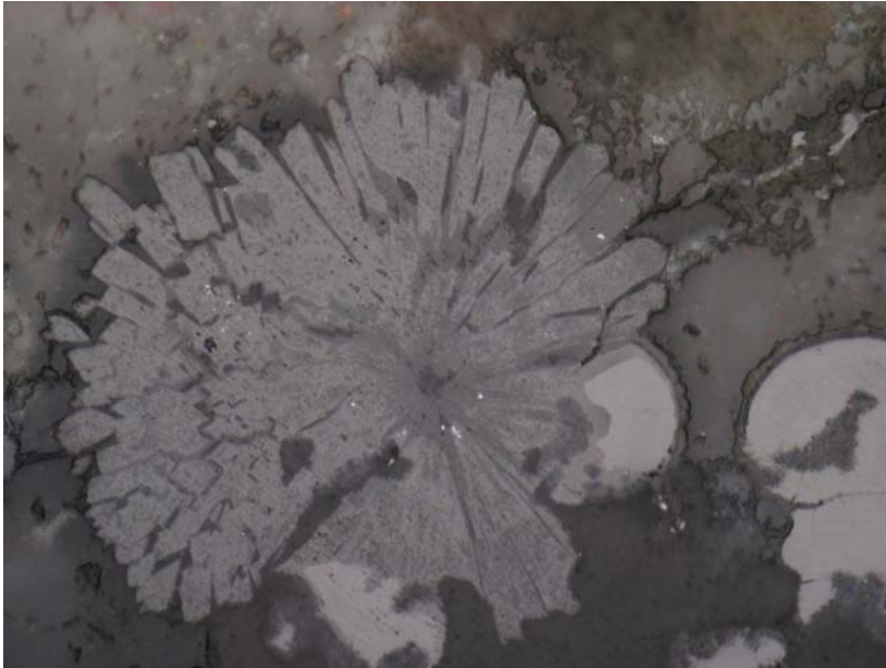
Obr. 1.13: Radiálně paprscitý agregát jehlicovitých krystalů coffinitu (šedý a nehomogenní vzhledem k variabilnímu chemismu a hydrataci). Tmavošedé – kalcit a křemen, světle šedý – uraninit. U-ložisko Zálesí u Javorníka. Spodní strana snímku měří 0,29 mm.
