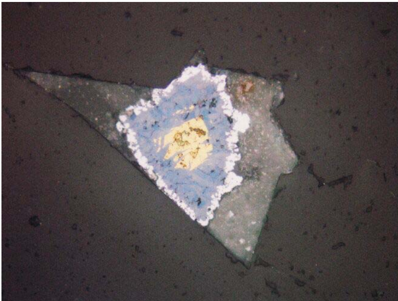
Obr. 1.26: Růstová zonálnost sulfidů. Zrno chalkopyritu (žlutý) je částečně zatlačováno covellínem (modrý, zřetelný dvojodraz) a následně obrůstáno tenkou zónou galenitu (bílý). Agregát rudních minerálů je v drobné dutince v křemenu (šedočerný), zbylý prostor dutinky vyplnil dolomit (světle šedý). Zlatý důl u Hluboček. Spodní strana snímku měří 0,29 mm.
