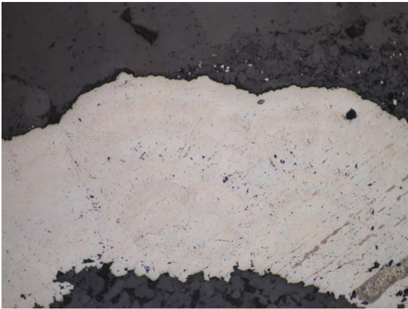
Obr. 1.31: Růstově zonální agregát sulfidů s rytmicky se střídajícími zónami pyritu (světle krémový) a markazitu (bílý). Kalcit-pyrit-markazitová žilná mineralizace z lomu Hrabůvka. Spodní strana snímku měří 1,44 mm.
