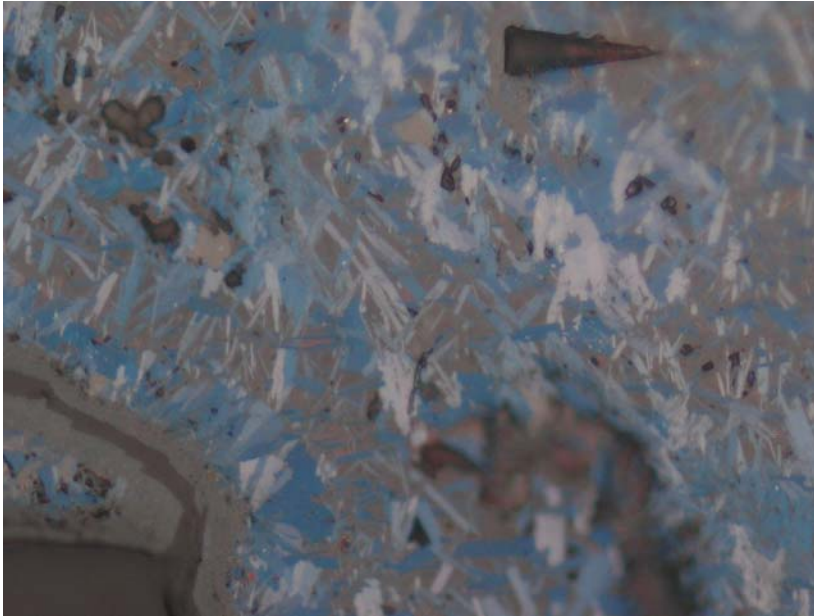
Obr. 1.10: Lepidoblastická struktura covellínu (modrý, silný dvojdraz) v agregátu supergenních fází zatlačujících primární sulfidy. Polymetalické ložisko Jasenie, Nízke Tatry. Spodní strana snímku měří 0,20 mm.
