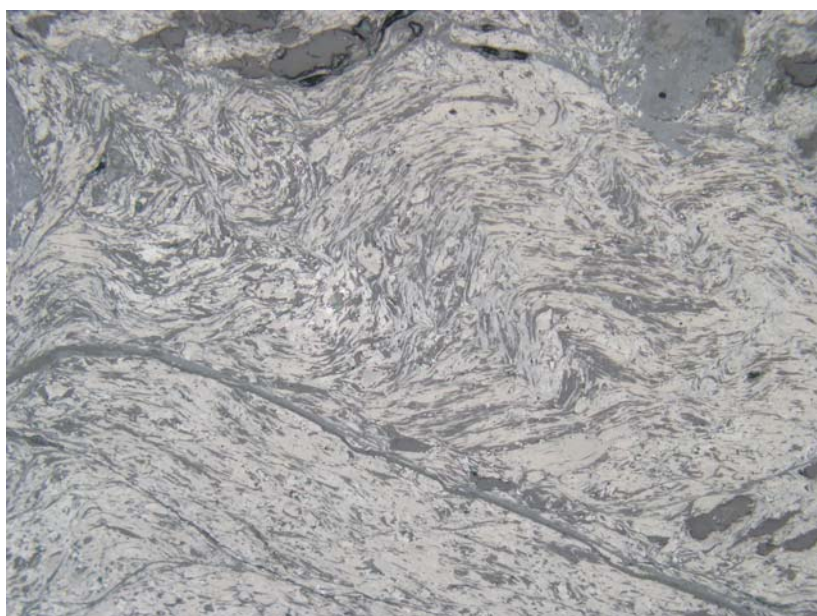
Obr. 1.9: Lepidoblastická struktura grafitu (světlý). Dobře je patrné detailní provrásnění grafitu. Vpravo nahoře izometrické zrno pyritu změněného v „limonit“ (šedé). Ketkovice. Spodní strana snímku měří 0,72 mm.
