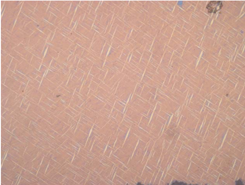
Obr. 2.2: Detail mřížovitého systému odmíšenin chalkopyritu v bornitu z Markovic (z obr. 2.1). Spodní strana snímku měří 0,29 mm.
