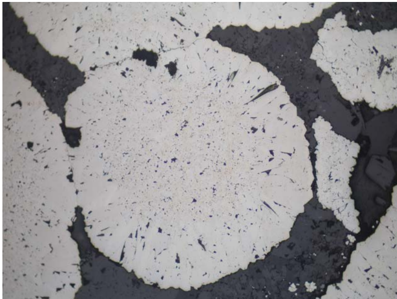
Obr. 1.29: Kulovité agregáty markazitu (bílý s patrným dvojdrazem) uzavírané v kalcitu (šedočerný). Kalcit-pyrit-markazitová žilná mineralizace z lomu Hrabůvka. Spodní strana snímku měří 1,44 mm.
