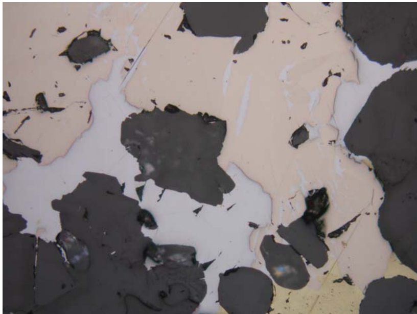
Obr. 2.13: Nepravidelné až pentlicovité inkluze galenitu (bílý) v pyrotinu (hnědý). Jde o heterogenní vrostlice. Na snímku dále chalkopyrit (zlatožlutý) a křemen (šedočerný). Polymetalické zrudnění kutnohorského typu, lom Pohled u Příbyslavi. Spodní strana snímku měří 0,72 mm.
