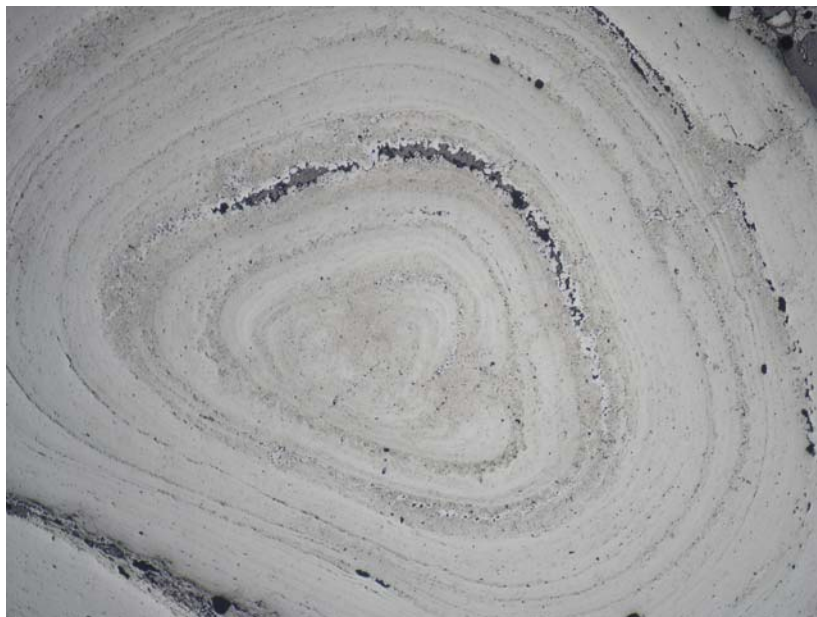
Obr. 3.1: Růstová zonálnost oolitu ze sedimentární limonitické železné rudy. Jednotlivé zóny se liší chemicky a proto i odrazností. Lokalita neznámá. Spodní strana snímku měří 3,6 mm.
