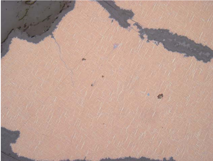
Obr. 2.1: Odmíšeniny chalkopyritu (světlé) v bornitu (načervenalý). Příklad mřížovité struktury rozpadu pevného roztoku. Od okrajů a po puklinách jsou sulfidy zatlačovány limonitem (šedý). Alpská paragenese, lom Markovice. Spodní strana snímku měří 0,72 mm.
