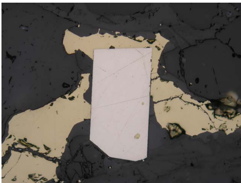
Obr. 4.6: Automorfně omezený metakrystal pyritu (světlý) v rudnině tvořené chalkopyritem (zlatožlutý) a křemenem (šedočerný). Pyrit obsahuje ojedinělé inkluze chalkopyritu. Polymetalické ložisko Zlaté Hory. Spodní strana snímku měří 0,72 mm.
