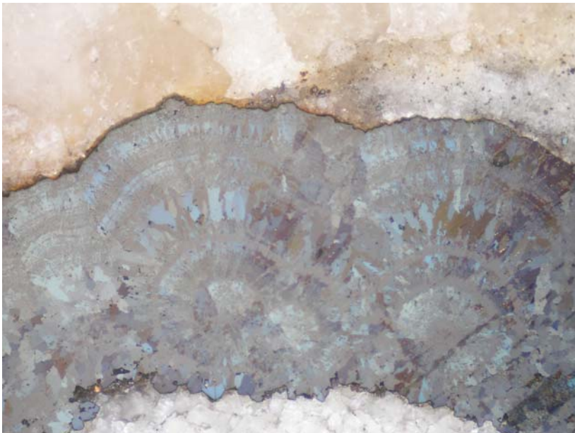
Obr. 1.32: Rytmické střídání růstových zón pyritu (izotropní, šedivý) a markazitu (silně anizotropní, modré až hnědé polarizační barvy) v sulfidickém agregátu z lomu Hrabůvka (obr. 1.31). XPL, mírně rozkřížené nikoly. Spodní strana snímku měří 1,44 mm.
