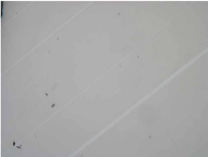
Obr. 1.35: Dvojčatné lamely v ilmenitu. Lamely jsou průběžné, nestejně mocné. Pegmatitové ložisko Hatě, Dolní Bory. Spodní strana snímku měří 0,72 mm.
