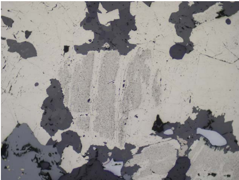
Obr. 1.23: Zonální stavba pyritu. V centru je minerál porézní a špatně leštitelný, při okrajích neporézní a dobře leštitelný. Pyrit uzavírá inkluze křemene (šedočerný) a sfaleritu (šedý). Polymetalické ložisko Zlaté Hory. Spodní strana snímku měří 1,44 mm.
