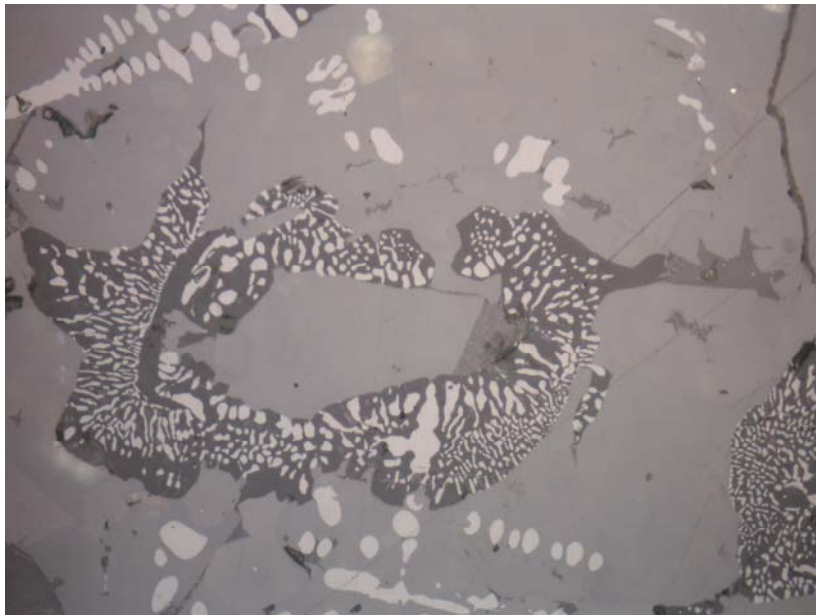
Obr. 2.4: Odmíšeniny wüstitu (bílé) v leucitu (nejtmavší). Nejsvětlejší šedá - fayalit, středně šedá mezerní hmota - sklo. Fayalit v sobě uzavírá velká individua wüstitu starší generace. Železářská struska, středověk, lokalita Stříbrné hory. Příklad myrmekitové struktury. Spodní strana snímku měří 0,29 mm.
