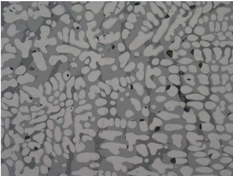
Obr. 1.5: Eutektické srůsty fayalitu (šedý) a wüstitu (nejsvětlejší). Tmavošedé – sklo, černé – drobné póry. Železářská struska, středověk. Stříbrné Hory. Příklad eutektické struktury. Spodní strana snímku měří 0,72 mm.
