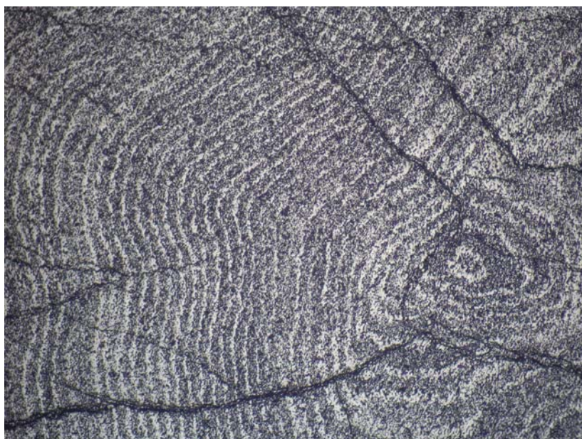
Obr. 3.2: Oscilační růstová zonálnost konkrerce Mn-oxidů z jílových sedimentů magurského flyše. Jednotlivé zóny se liší porozitou a proto i leštitelností. Lokalita Obřany u Bystřice p. Hostýnem. Spodní strana snímku měří 3,6 mm.
