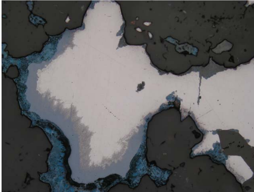
Obr. 4.15: Zatlačování galenitu (bílý) zonálním agregátem supergenních minerálů: šedý - cerusit, modrošedý - chalkozín, sytě modrý - covellín. Šedočerný - křemen. Pb-Zn ložisko Jasenie, Nízke Tatry. Spodní strana snímku měří 1,44 mm.
