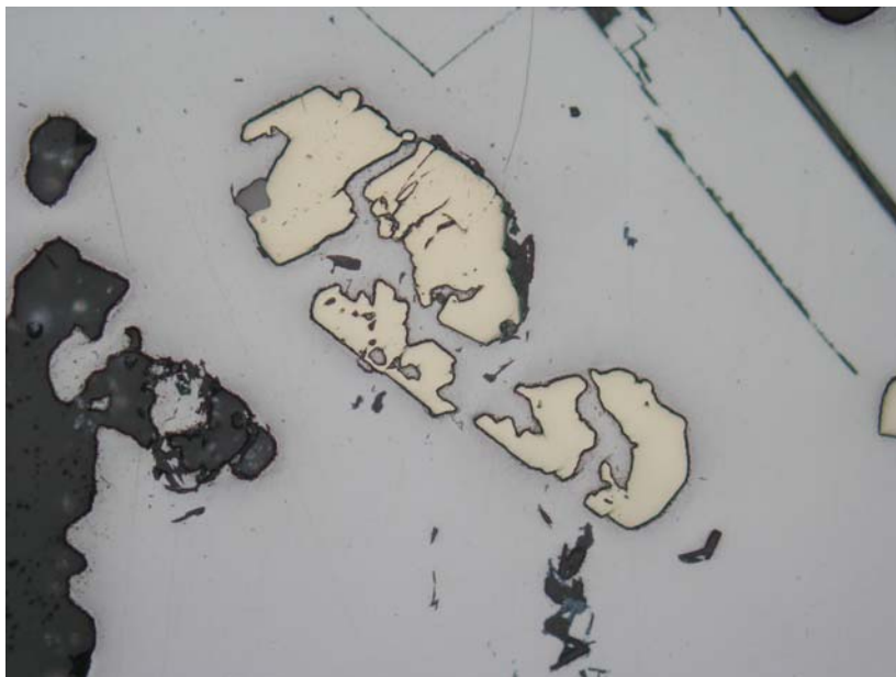
Obr. 4.3: Zatlačování pyritu (krémový) galenitem (bílý). Polymetalické ložisko Jasenie, Nízke Tatry. Spodní strana snímku měří 0,72 mm.
