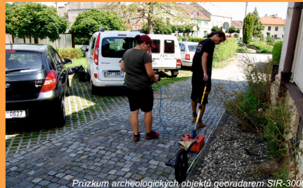
Průzkum archeologických objektů georadarem SIR-3000
