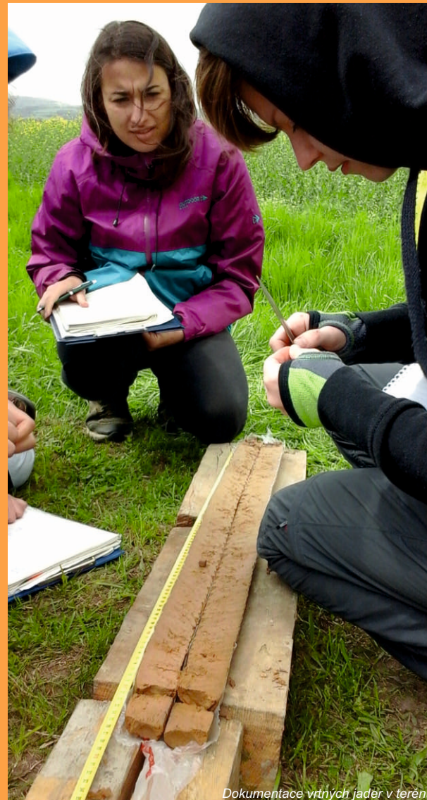
Dokumentace vrtných jader v terénu
