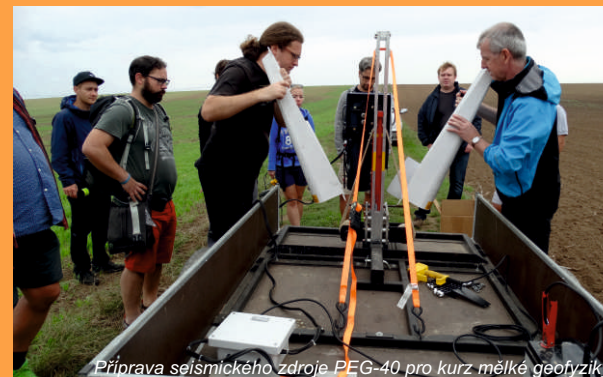
Připrava seismického zdroje PEG-40 pro kurz mělké geofyziky
