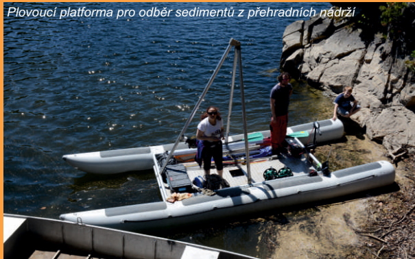
Plovoucí platforma pro odběr sedimentů z přehradních nádrží
